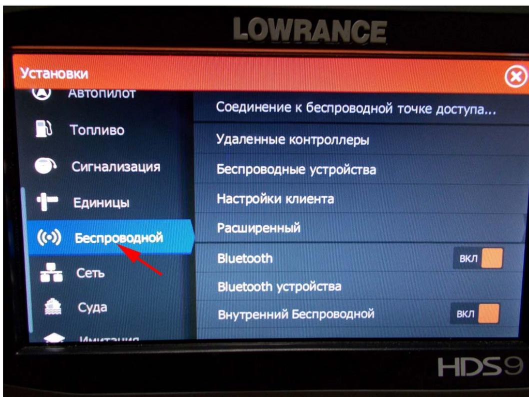
Пункты "BlueTooth" и "внутренний беспроводной" должны быть включены (если нет, то нажать для включения). Выбираем нажатием "беспроводные устройства".
