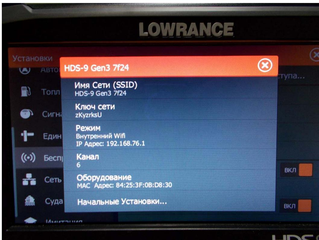
На мобильном устройстве включаем WiFi соединение, находим нужную сеть, вводим пароль и подключаемся.
